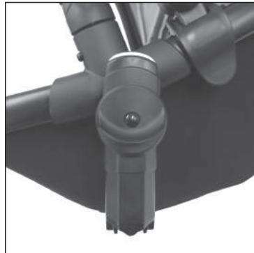
Вставляйте крепления прогулочного блока в основные пазы/гнезда шасси, пока не услышите, что сиденье зафиксировалось со щелчком.
